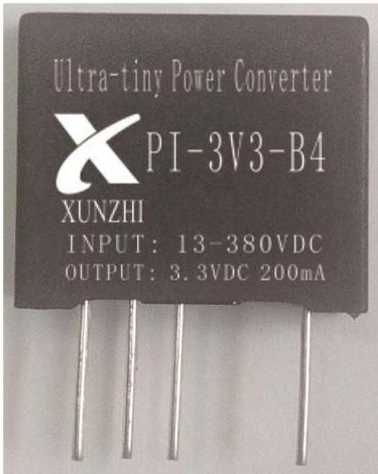
该系列产品为 SIP 4 脚插针结构的超小型 DC/DC 电源，其尺寸为 L18\*W9.5\*H15.5mm，体积很小。其特点是：由于采用了先进的电路结构，非常适合运用在 ZigBee 智能开关等智能家居产品中大量广泛应用，目前已经成功应用于多个智能家居产品中，如智能插座（零火线）、智能开关（单火线）等。
