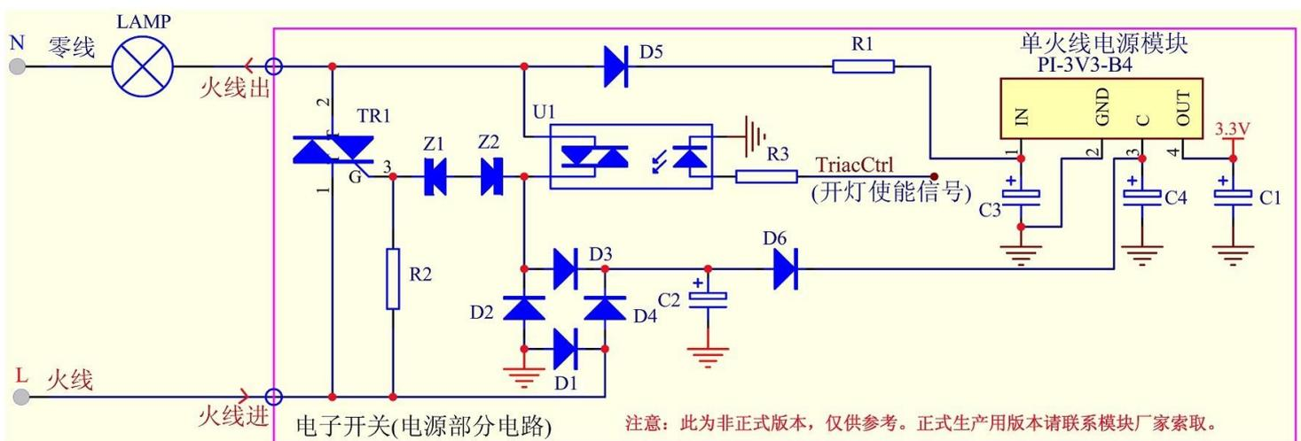
有些朋友会问：既然称为单火线开关是不是不需要零线都能工作，其实“单火线”是相对电子开关盒来说的（只需要接入火线到开关盒中，不需要接入零线到开关盒中），对整个电路来说，实际上也是经过零火线来工作的，只不过借用了灯具作为连接零线的通路，这就产生了一个问题，由于节能灯或 LED 类灯具只要通过很小的电流，在关灯时都会产生闪烁发光现象，特别是 LED 灯闪光的时候非常亮，这个电流一般不能大于  $30\mu\text{A}$ ，当然有些灯具大一些（例如  $100\mu\text{A}$ ）也不会闪，但为了做成的开关能适应更多的灯具这个电流是越小越好。由于低功耗的电源模块转换效率一般都比较低，大都不超过 50%（优化后可以达到 65%），所以在输入电流  $30\mu\text{A}$  的情况下，低压输出端（OUT）能提供给控制电路使用的电流不会超过  $1\text{mA}$ （即使瞬间电流可以几十  $\text{mA}$ ，但平均电流都必须控制在  $1\text{mA}$  以下）。
